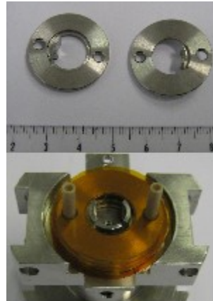
Fig 60: anneaux défecteurs En haut: vue des deux faces En bas: montage des défecteurs avec isolation par des feuilles de Kapton (films de couleur orange)
