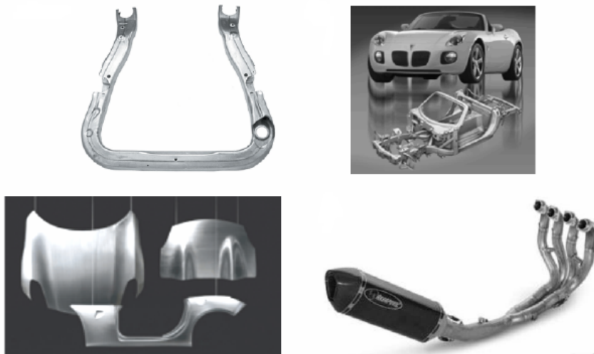
FIGURE 1.1 – Exemple de pièces obtenues par hydroformage [Maki & Walter 2007]
