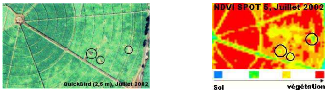
Figure 12. Zone de faible développement dans une parcelle de canne irriguée par pivot central, exploitation de Médine, Ile Maurice ; à gauche, image QuickBird à 2,5m de résolution et à droite image SPOT 5 à 10m de résolution spatiale.
