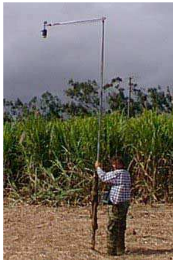
Photographie 2. Prise de mesures au radiomètre Cimel CE-310 sur du pailis.
