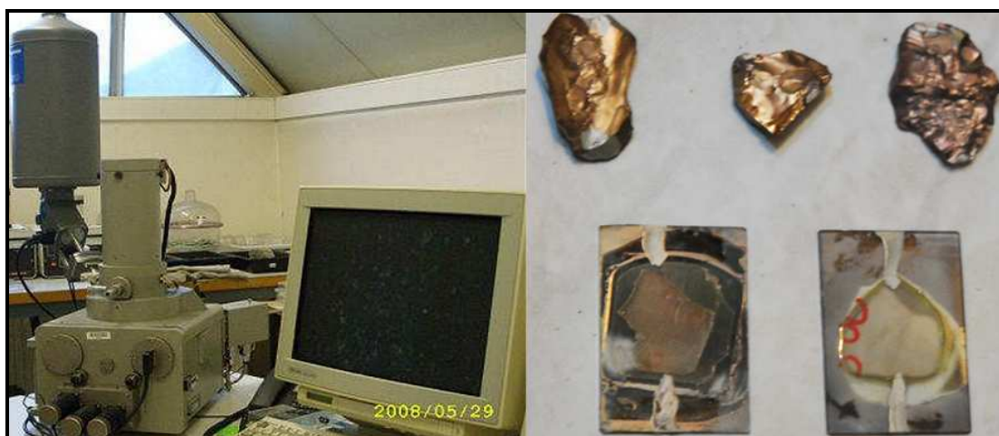
Figure 2.7 : (a) Microscopie électronique à balayage (MEB) LEICA S430i du L2MGC, à gauche, (b) Silex et lames minces métallisés à observer sous MEB, à droite.
