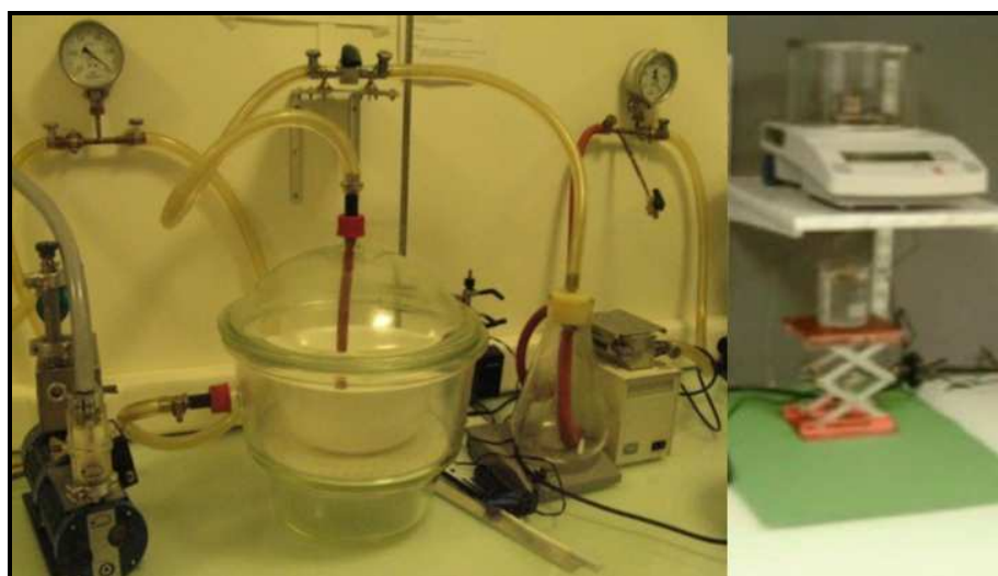
Figure 2.6 : Dispositif de mesure de porosité, a) la cloche en verre hermétique, à gauche ; b) la balance électronique, à droite.
