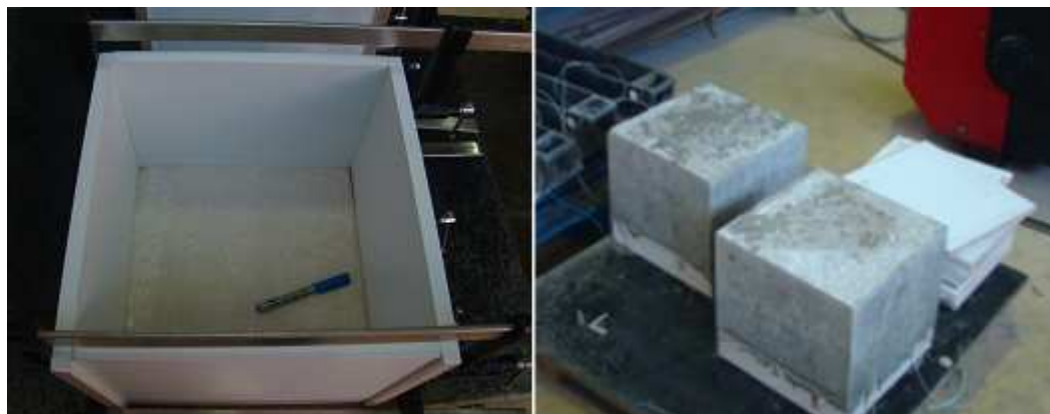
Figure 5.2 : Coffrage et éprouvette de bicouche, a) coffrage, à gauche, b) éprouvette après démoulage, à droite.
