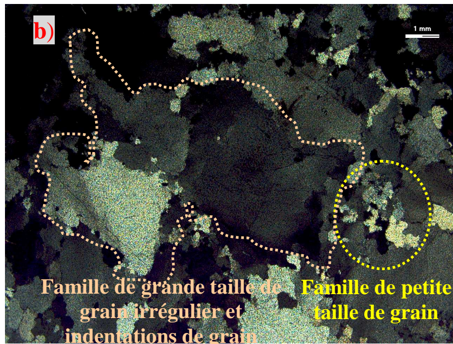
Figure 3.26 : Photographies d'un granulats de quartzite marron (échantillon I2), a) observation macroscopique, b) observation au microscope optique en lumière polarisée et analysée.
