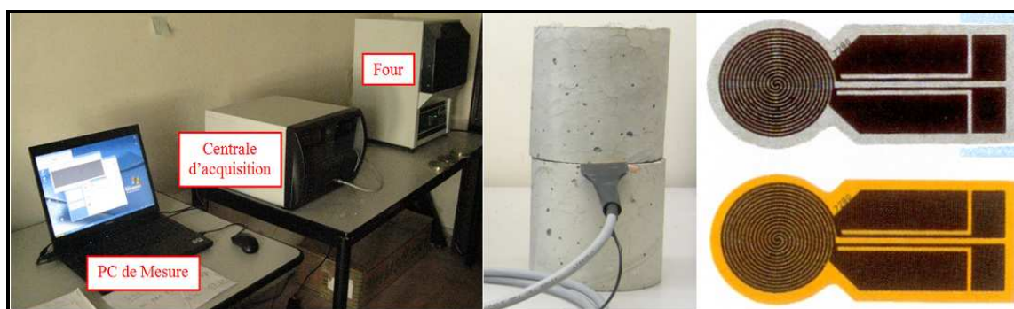
Figure 2.15 : Mesures des propriétés thermiques des bétons après le cycle de chauffage-refroidissement, a) le dispositif du Hot-Disk, à gauche ; b) disposition de sonde, au centre ; c) la sonde de kapton en bas et la sonde de mica en haut, à droite.
