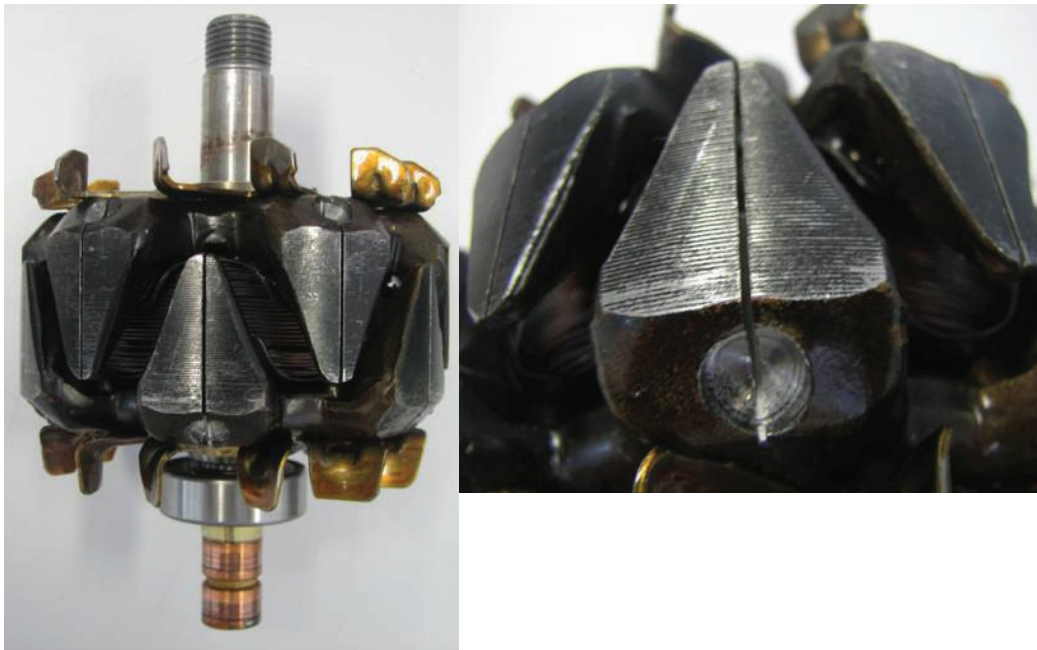
Fig 4.6- Fentes dans le rotor
