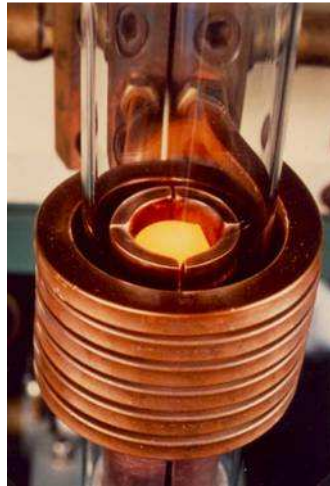
Figure 2-1 : Four à induction haute fréquence (200 MHz).
