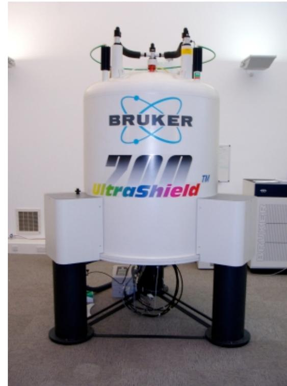
Spectromètre RMN 700 MHz (16,4 Tesla)
