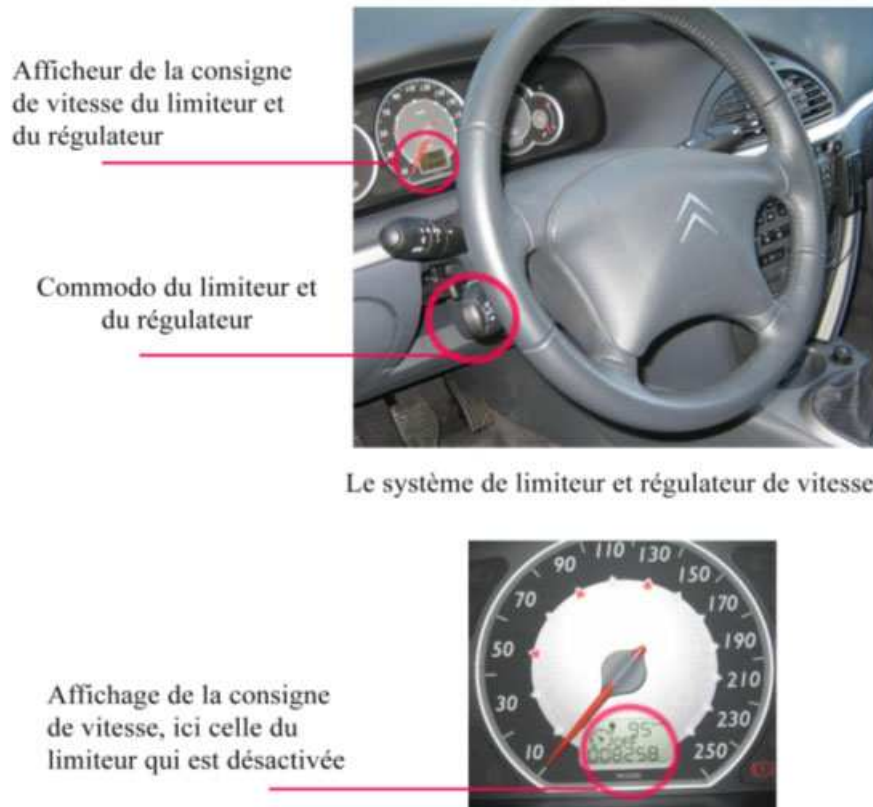
Figure 24 : Photographies des commandes et de l'afficheur du limiteur- régulateur de vitesse.
