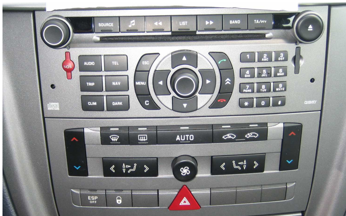
Figure 19 : La console principale permettant les opérations sur le système embarqué.
