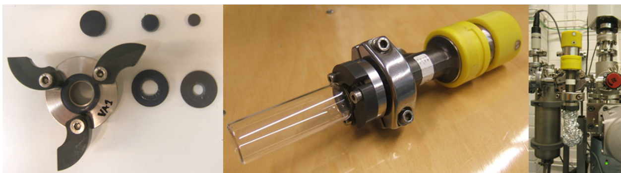
FIGURE 5.15 – a. Système fixation des fioles sur la vanne. b. Nouvel adaptateur à vide monté sur la vanne micrométrique. c. test sur le spectromètre de masse QMS. / a. Adaptator for the vials on the valve. b. Adaptator mounted on a micrometric valve. c. Test on the QMS mass spectrometer.
