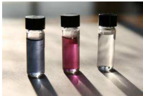
Fig.34 : Solution de nanoparticules d'or, en fonction de la forme des nanoparticules, la solution apparaît avec diverses colorations. De gauche à droite : nanobâtonnets d'or de 14 nm de diamètre et 25 nm de long ; synthèse par radiolyse de nanoparticules d'or sphériques de 15 nm de diamètre - synthèse par voie chimique selon la méthode dite de Turkevich. Flacon d'eau... contenant des particules à base d'or de grande taille (1mm) [81].
