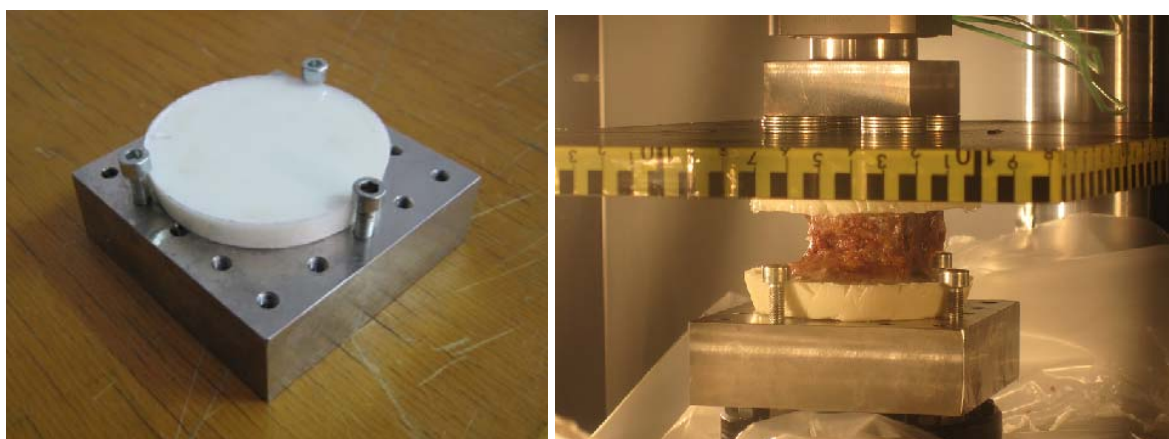
Figure 3.9 : Le plateau de résine est bloqué par des vis placées sur le support (à gauche) – positionnement de la vertèbre préalablement à l'essai (à droite)
