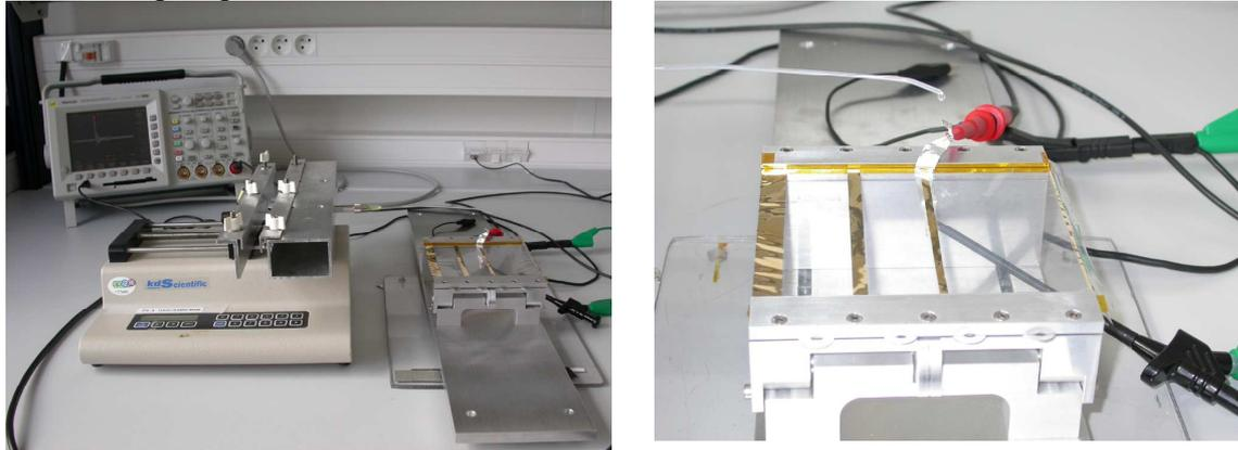
**Figure 78 : Montage simplifié permettant l'apport de  $2 \mu\text{J}$  au matériau piézoélectrique**
