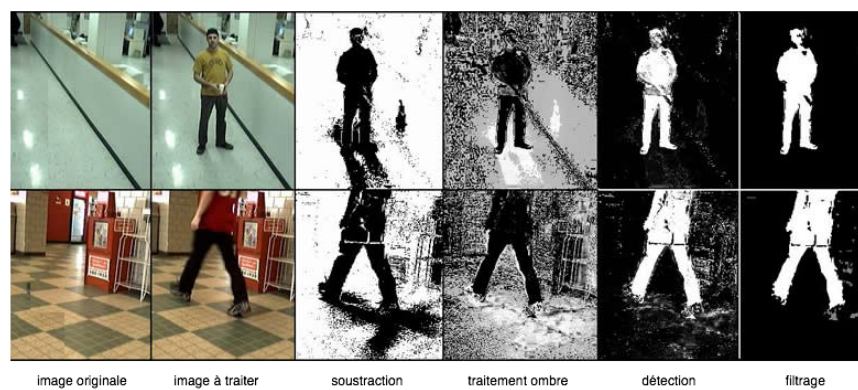
Figure 3.4 — Les différentes étapes permettant l’obtention du masque des objets en mouvement par extraction du fond.
