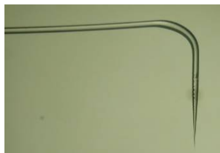
Figure 35 : Pointe cintrée d'une fibre en polymère (PMMA).
