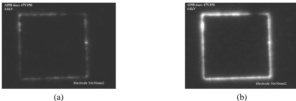
Figure II - 12 : Localisation de la lumière émise sur le substrat AIN8 dans l'huile silicone, a : 4kV_{eff} et b : 7kV_{eff} .
