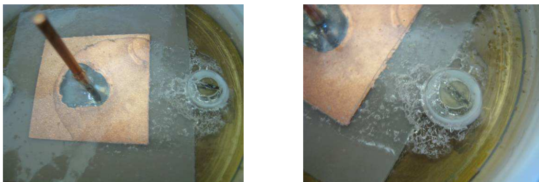
Figure A - 12 : Apparition de fissures dans la cellule de mesure après conditionnement à -60^{\circ}\text{C} .
