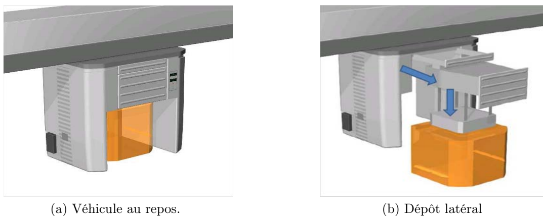
FIGURE 2.5 – Dépôt latéral d'un lot par un véhicule au plafond.
