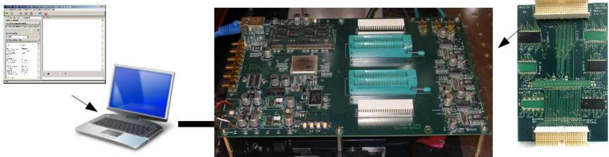
Figure IV-2 : Testeur ELECTRE utilisé pour le test de DRAMs au laser et en accélérateur de particules
