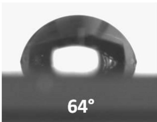
*Figure 3.17 : Photographie d'une goutte d'eau déposée sur une surface d'or fonctionnalisée par une monocouche de 4,4'-azobis-4-cyanopentanoate de (1,10-dimercaptodécyle).*
