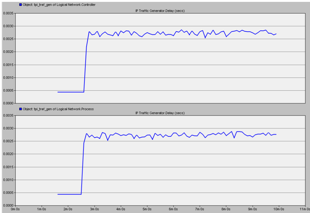
Figure 2.20. Evolution des délais aux niveaux du contrôleur et du process en présence de la charge (cas du WRR avec w_{Trafic_{TR}} = 30 et w_{Trafic_{TF}} = 1 )
