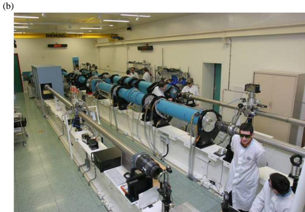
Fig. 4.1- Le laser Alisé : (a) Schéma de l'installation. (b) Photo de la chambre d'amplification.
