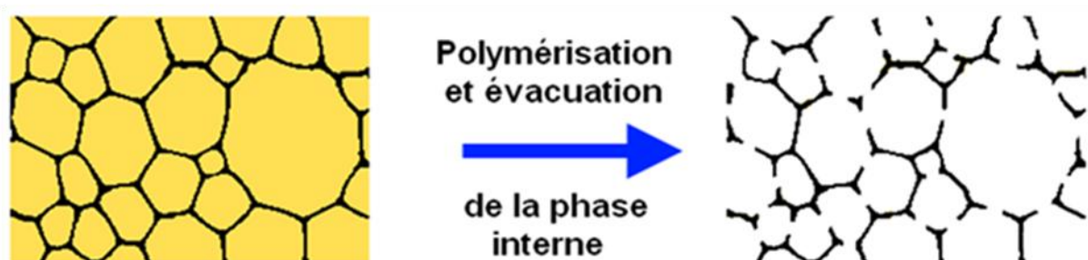
Figure 56 : Schéma représentatif de la réalisation d'une mousse de polymère à partir d'une ETC.
