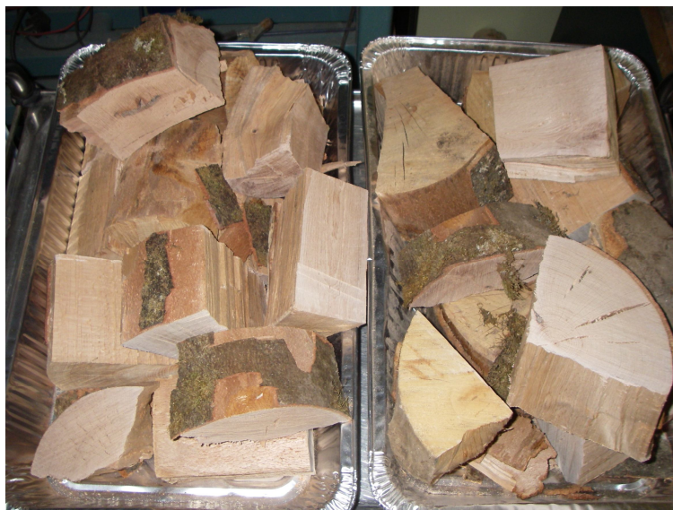
Figure 5.2 : Photographie du conditionnement des morceaux de bois utilisés lors de la simulation de la combustion de bois dans une cheminée domestique.
