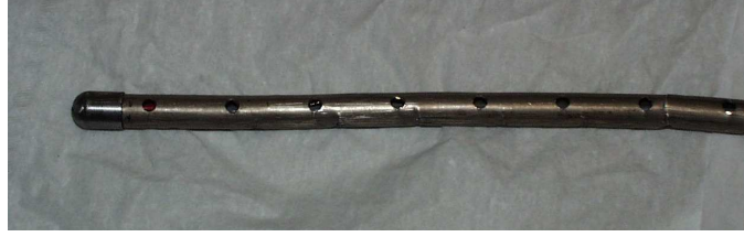
Figure II.4 : Tube métallique percé contenant la jauge de niveau
