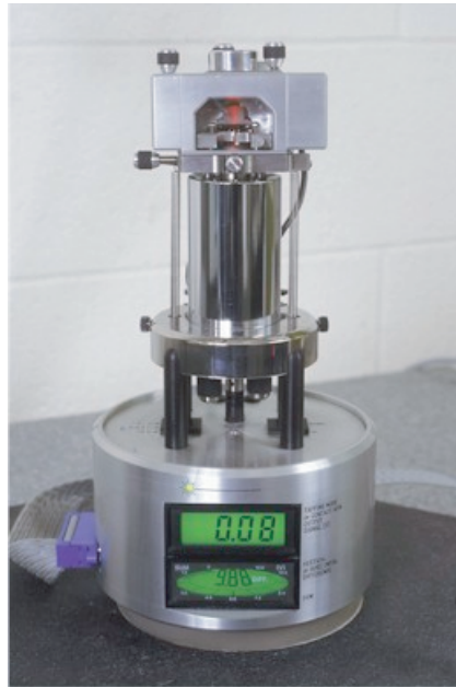
FIG. 3.20 – Le microscope Multimode Nanoscope IV de la Digital Instruments utilisé pour obtenir les images.
