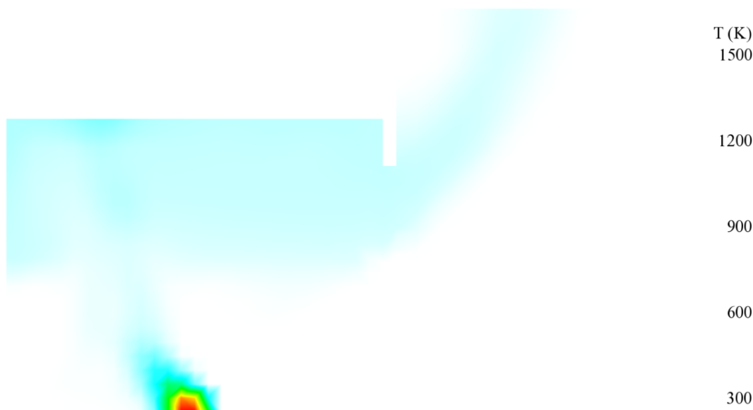
FIG. 6.24 – Champ moyen de la température dans le plan de symétrie pour \dot{Q} = 62.9 \text{ kW} .
