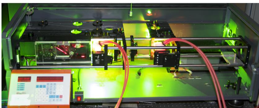
FIGURE IV.9: Photo d'un laser à colorant Lambda-Physik modèle FL3002.
