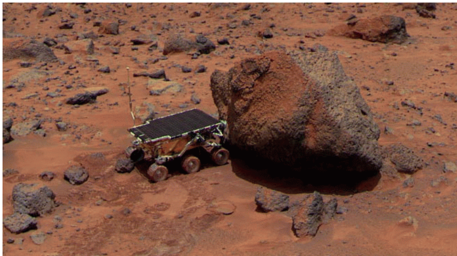
FIG. 3.2 – Sojourner sur la planète Mars. Ce robot est semi-autonome, il dispose d'algorithmes lui permettant d'éviter les obstacles simples alors que les obstacles trop importants requièrent l'intervention d'un opérateur humain, tâche rendue difficile par les délais de communication entre la planète Terre et la planète Mars.
