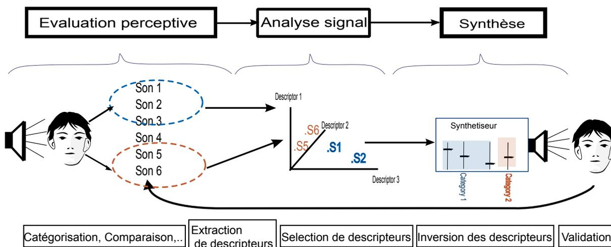
Figure 1 – Synoptique de la méthode générale proposée
