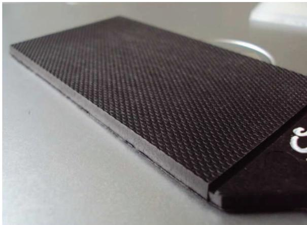
FIGURE 4.31: Motifs en surface des éprouvettes d'impact
