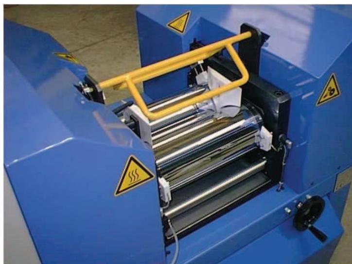
FIGURE 1.42: Broyeur à rouleaux
