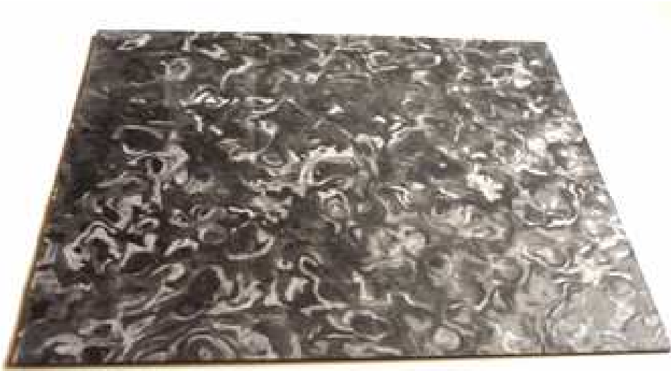
Fig. II-8 : Le composite HexTOOL™ obtenu après usinage. Type de plaque utilisée dans notre étude
