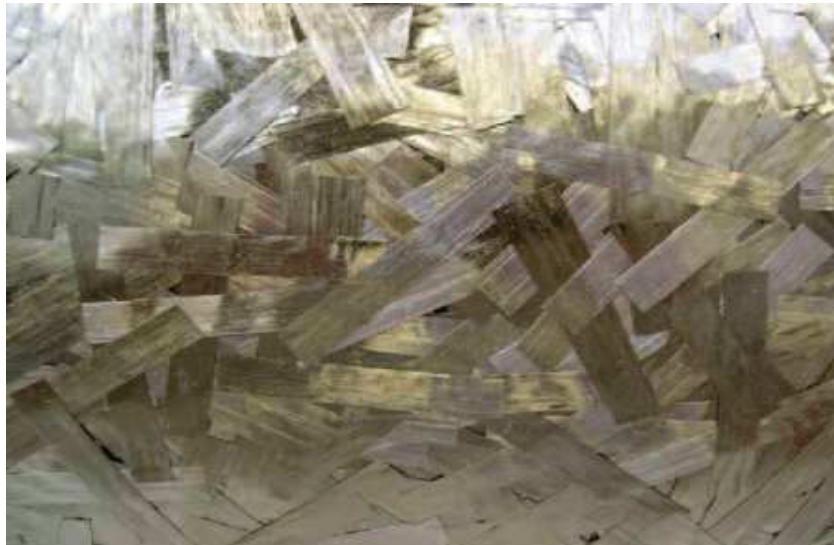
Fig. II-3. Dispersion des mèches de fibre de carbone dans un pli du composite [89].
