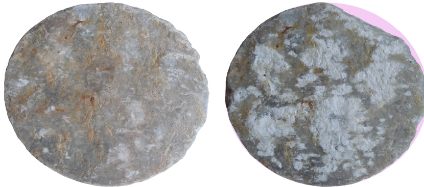
Figure 5.18 - Photo de la surface de l'éponte inférieure 05 avant (à gauche) et après (à droite) essai de cisaillement.
