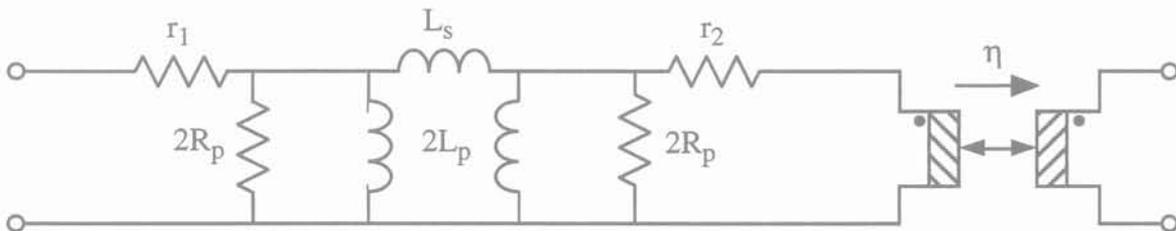
Figure A1-2: Circuit équivalent basse fréquence
