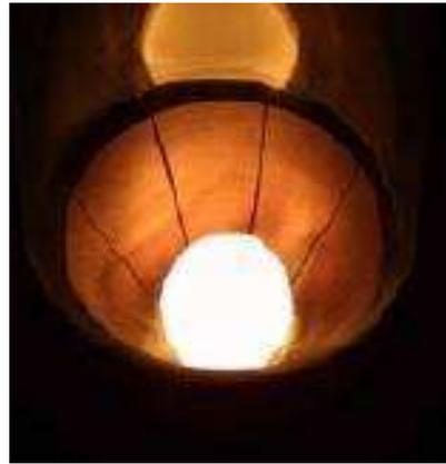
**Figure 2-1 : Échantillon en fusion dans le four à induction haute fréquence**
