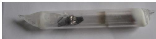
**Figure 2-3 : Ampoule de silice soudée contenant l'échantillon dans le feuillard de Tantale**
