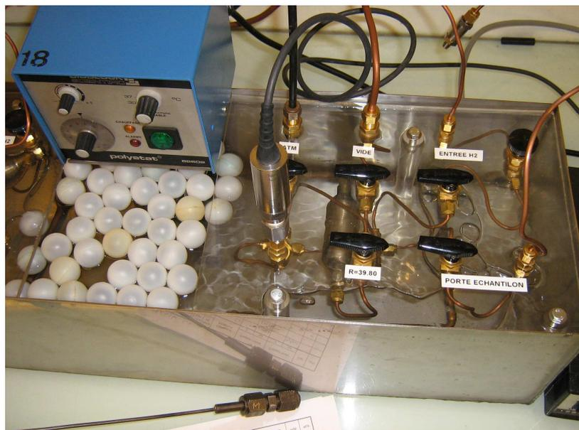
Figure 2-8 : Banc de mesure de PCT 100 bars
