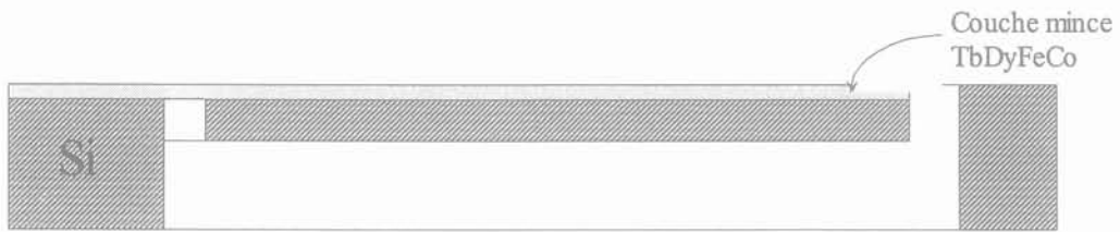
Figure 2-13. Vue en coupe de droite du bilame et de son cadre
