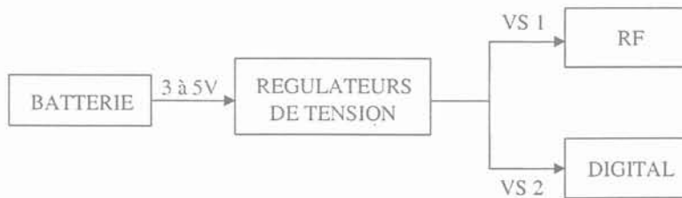
F1.1-2 : Répartition simplifiée des circuits intégrés et des tensions d'alimentation d'un téléphone portable
