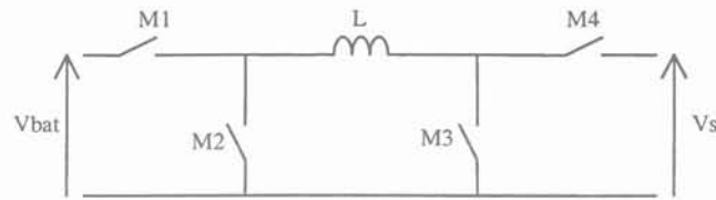
F 3.3-12 : Structure choisie pour le cœur du SMPS
