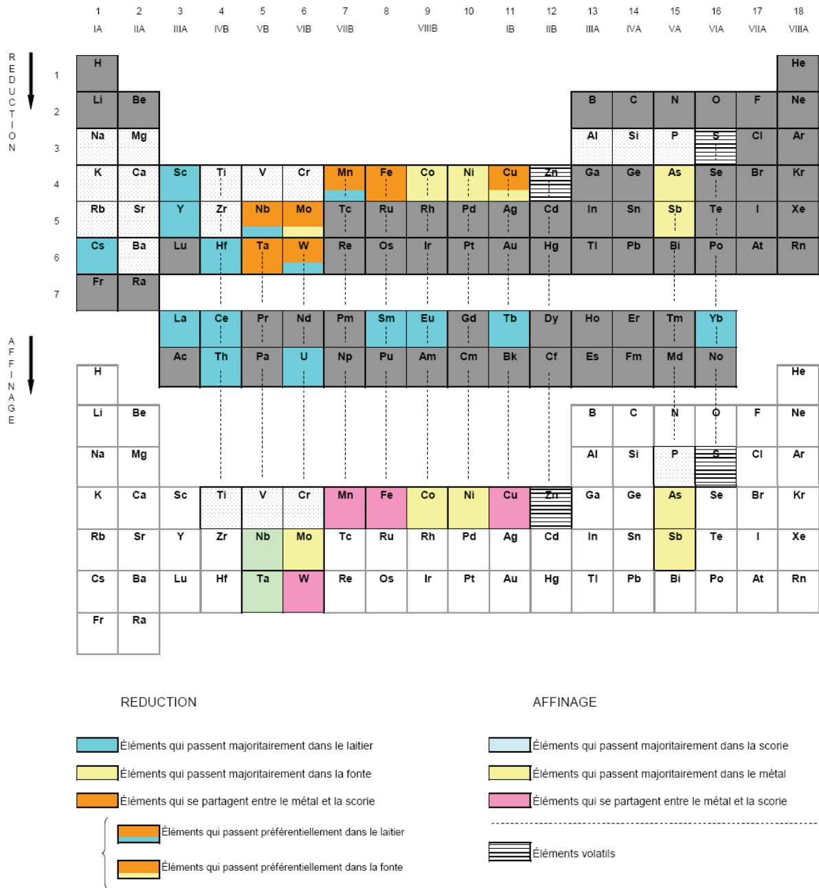
Figure I.3 – Comportement des éléments lors du procédé indirect (Desaulty, 2008)
