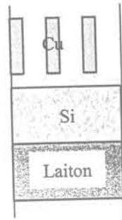
Fig. II.52 : Schéma FLUX2D pour l'étude des courants de Foucault
