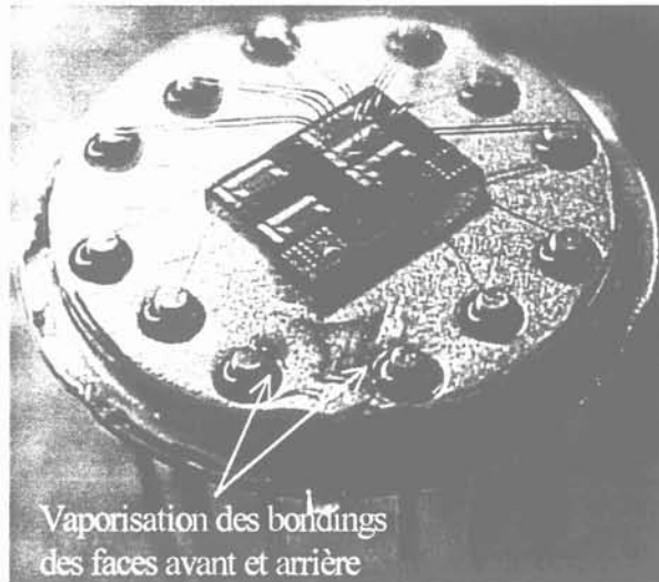
Figure II.56 : Etat des bondings après l'apparition d'un arc électrique entre face avant et face arrière de la puce.
