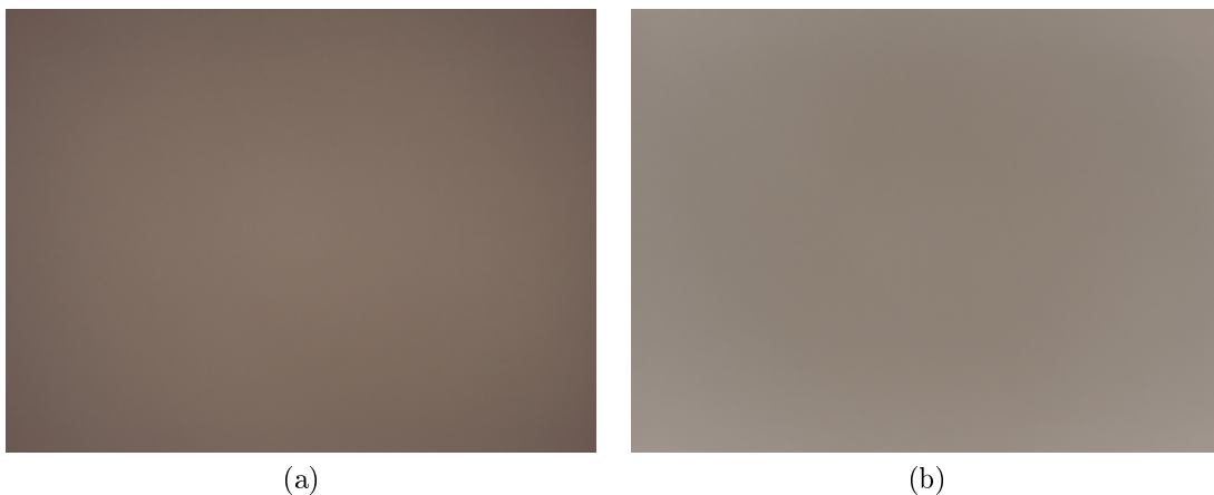
FIG. 4.16 – Correction de la variation de sensibilité et du vignelage : log-luminance non corrigée (a) et log-luminance corrigée (b).
