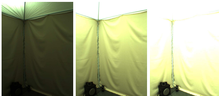
FIG. 3.43 – Acquisition d'une scène fixe avec une caméra mvBlueFox121-C à 50\,000\mu s , 200\,000\mu s et 400\,000\mu s .
