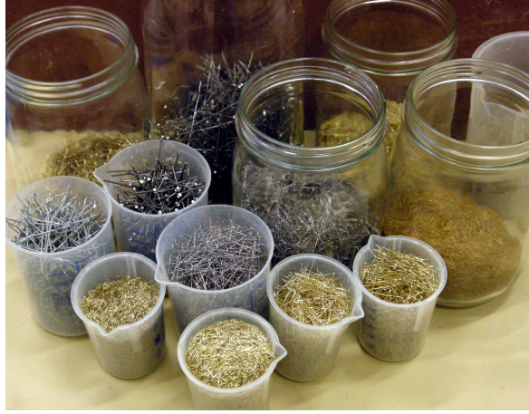
FIGURE 3.2 – Volume apparent occupé par des fibres de facteurs d’aspect variés organisées aléatoirement.
