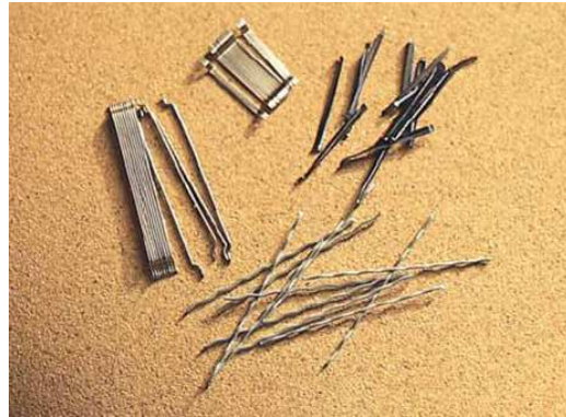
(b) Fibres métalliques (cf. http://www.infociments.fr )
