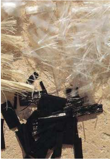
(a) Fibres synthétiques (cf. http://www.planete-tp.com )
