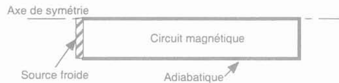
Figure III-45 : Simulation source froide + circuit magnétique
