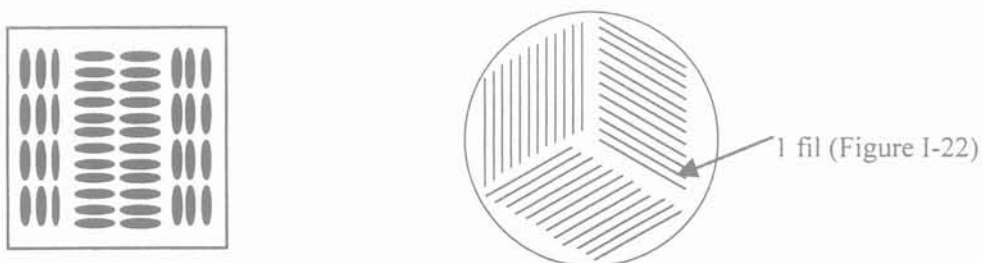
Figure I-23 : Conducteur PIT à anisotropie réduite
