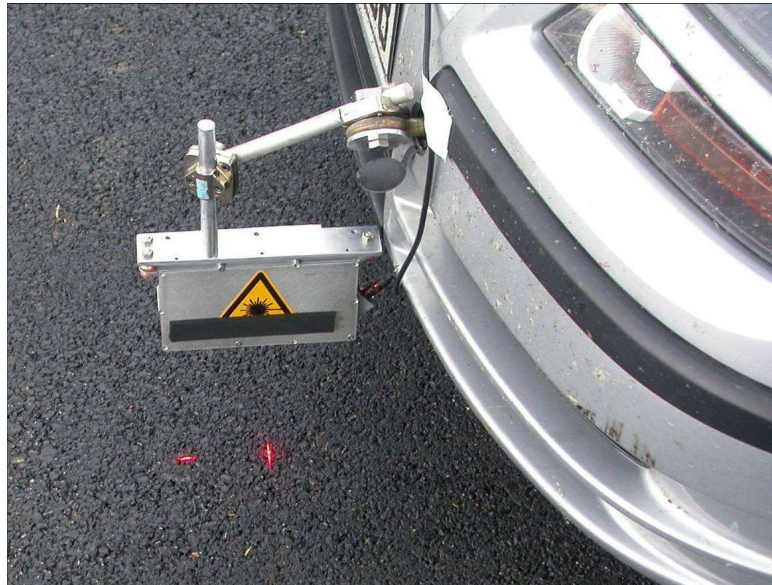
FIGURE 5.5 – Viseur laser pour estimer la distance entre la route et le véhicule
