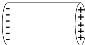
FIGURE 2.4 – Modélisation d'un barreau aimanté par l'approche coulombienne
