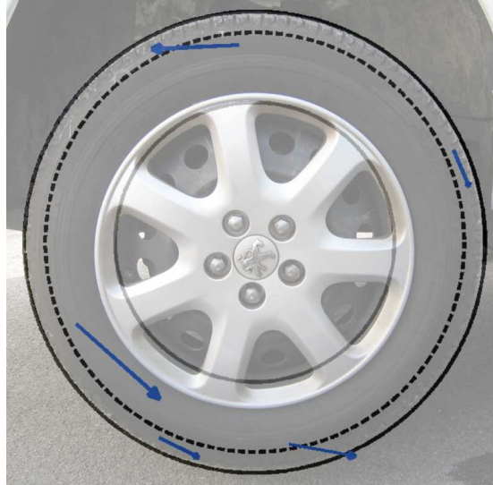
FIGURE 4.10 – Modélisation magnétique dipolaire de la roue après optimisation
