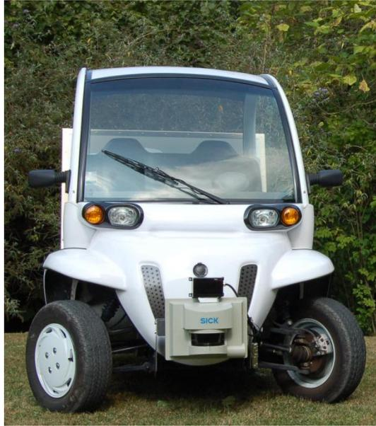
Figure 5.1 : Plate-forme expérimentale électrique automatisée : « Gem Car » équipée par le laboratoire SeT de l'UTBM.
