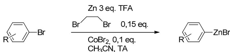
Schéma 90 : Voie de synthèse d'organozinciques utilisée durant les travaux de thèse
