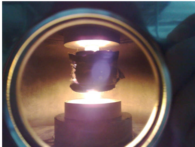
Figura 15 – Foto do sistema (pastilhador + pistão) durante o processo de sinterização em uma temperatura superior a 1000 °C.
