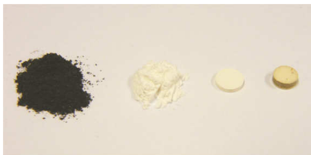
Figura 19 – Fotografia de uma das amostras obtidas durante as diferentes etapas do processo de preparação. Da esquerda para a direita tem-se a amostra obtida no processo de queima da resina a 300 °C, amostra obtida após o processo de calcinação a 1000 °C, amostra na forma de pastilha prensada (a verde) e a amostra na forma de pastilha após sinterização a 1200 °C.
