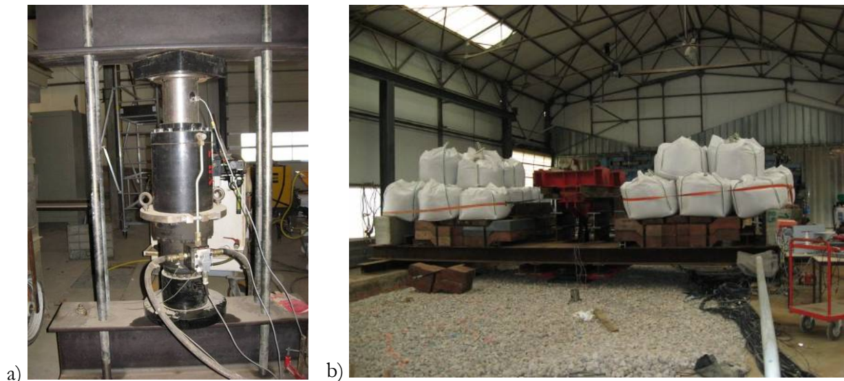
Figure 2-11 - Système de chargement statique : a) vérin de 1 MN, b) portique.
