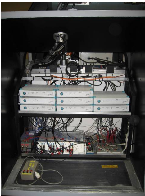
Figure 6-23 - Chaîne d'acquisition et de traitement des données. a) Spider 8 en place dans la nacelle, b) PC de commande et d'enregistrement des données.
