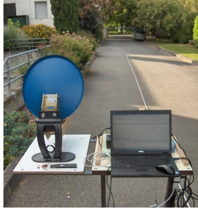
II-25 : Le radar avec une antenne parabolique (émission) et une antenne cornet (réception)
