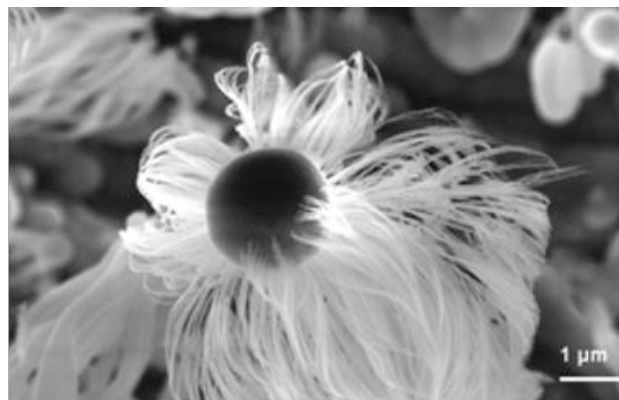
Figure 1.7 : Image MEB de croissance de Bi à partir de gouttes de Ga (Bhimarasetti, 2005)
