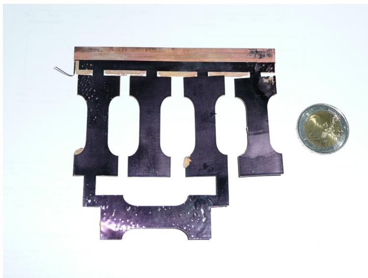
FIGURE II.8 – Eprouvettes réalisées par lithogravure chimique
