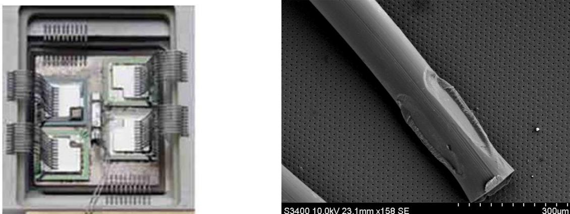
FIGURE I.8 – Observation de fils de bonding, vue d'ensemble (a), Observation au MEB (b)
