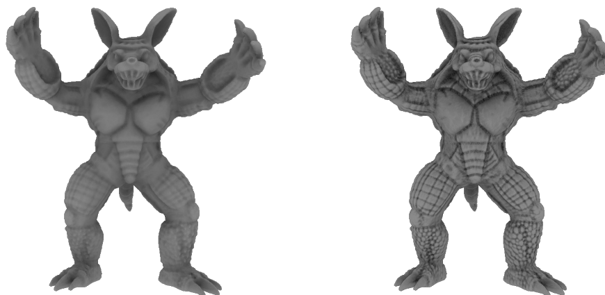
F . 5.11: À gauche : Ambient Occlusion classique. À droite : les rayons lancés sont modifiés avec notre technique pour révéler et exagérer de nombreux détails.
